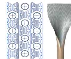
Воздушный конденсатор изготовлен из медных трубок с внутренней насечкой для увеличения интенсивности теплоотдачи при конденсации парообразного фреона. Медные трубки снаружи оребрены алюминиевыми ламелями для повышения коэффициента теплоотдачи со стороны наружного воздуха. V-образная конструкция теплообменной поверхности конденсатора обеспечивает компактность конденсатора. Конденсатор оснащен малозумными низкооборотными осевыми вентиляторами с пластиковыми крыльчатками.
