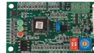
Плата управления сетевая (сетевой модуль) предназначена для подключения фанкойлов в единую сеть с пультом управления LZ-UPW7 или к контроллеру LZ-ModBus3.
