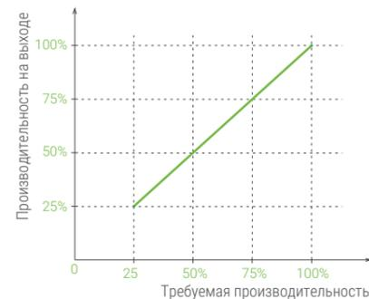
— Плавное регулирование производительности инвертором
