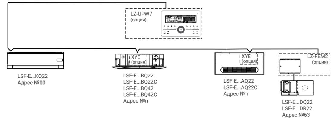
Принципиальная схема централизованного управления DC фанкойлами LESSAR по протоколу Modbus RTU. Перед оформлением заказа рекомендуется связаться со службой поддержки для получения консультации по тел. 8 800-333-0495 или отправить запрос по электронной почте на адрес: chiller@lessar.com.
