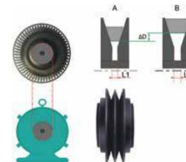
Принцип действия клиноремного вариатора основан на изменении вращающего момента за счет изменения рабочего диаметра шкива, т.е. при изменении расстояния L между коническими дисками шкива изменяется рабочий диаметр D данного шкива, что приводит к изменению скорости вращения вентилятора подачи воздуха в помещении при необходимости (не применяется в моделях на 22 и 26 кВт).
