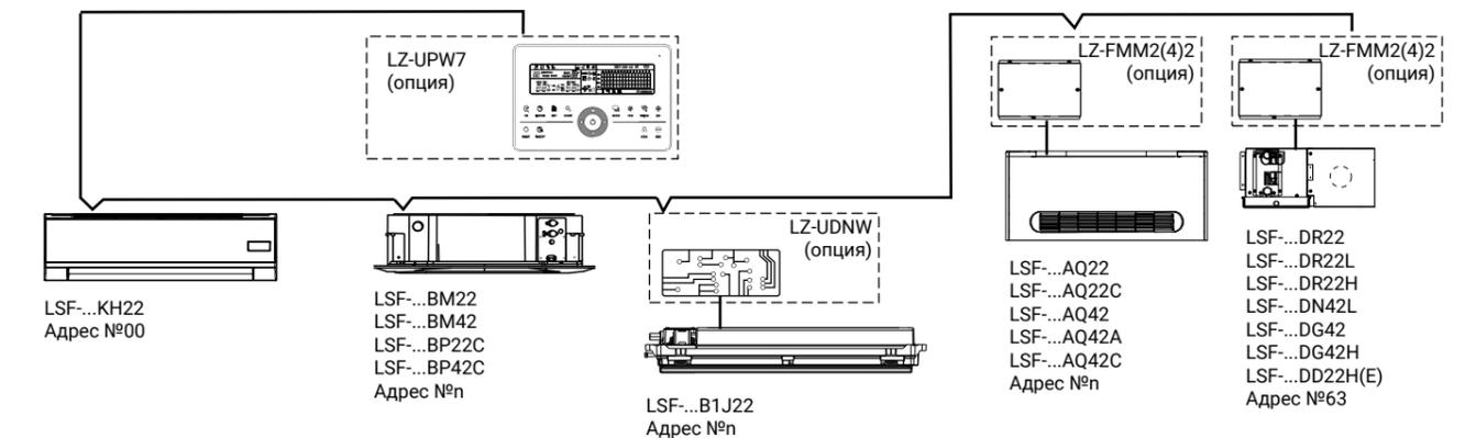
Принципиальная схема централизованного управления фанкойлами LESSAR по протоколу Modbus RTU.
