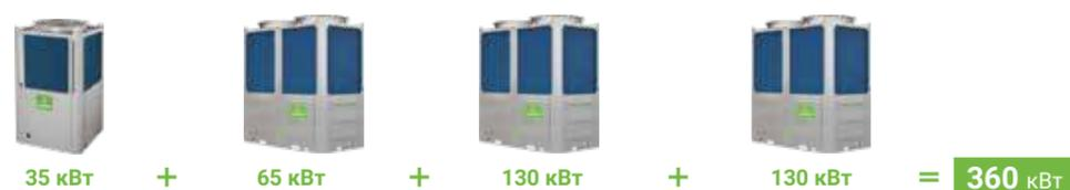
В модульных чиллерах LUC-FHA(D)(M)A...CAW установлены регуляторы скорости вращения вентиляторов воздушного конденсатора, что позволило расширить диапазон рабочей температуры наружного воздуха до  $-10\text{ }^{\circ}\text{C}$  в режиме охлаждения. Холодопроизводительность чиллеров от 35 до 250 кВт.
