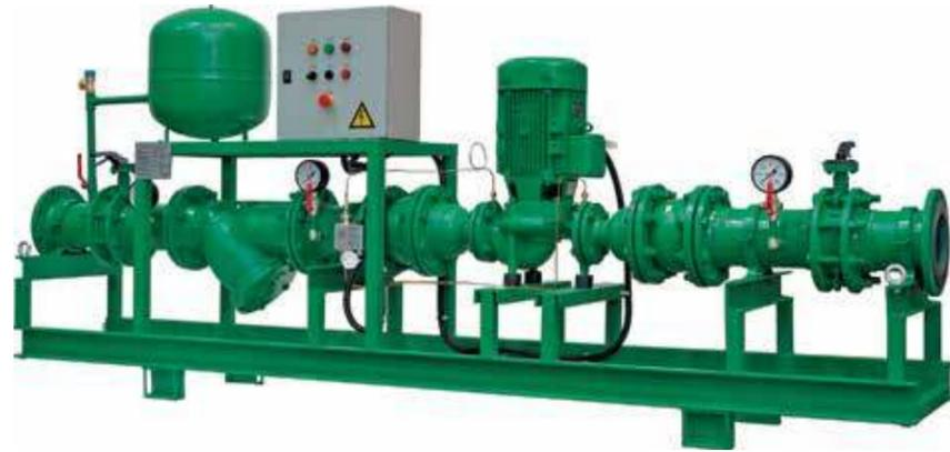
Для чиллеров LESSAR моделей LUC-... рекомендуется использовать гидравлические насосные модули LZ-CG. Гидравлические насосные модули LZ-CG предназначены для подачи чистой воды, водных растворов пропиленгликоля либо водных растворов этиленгликоля с концентрацией до 40% по объему без твердых (абразивных) включений. Гидравлические насосные модули LZ-CG разработаны для установки внутри помещения.
