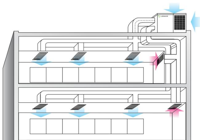
Принципиальная схема применения крышного кондиционера
