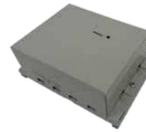
Индивидуальный проводной модуль. Подключается к гостиничному модулю чтения ключ-карт с сухими контактами. Предназначен для контроля работы оборудования в отелях. Включает фанкойл при наличии ключ-карты в модуле чтения и отключает фанкойл, если ключ-карту вынуть из модуля чтения.
