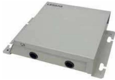
Блок управления (система группового управления) предназначен для организации управления работой фанкойлов с проводного пульта управления LZ-FMPW2, также необходим для подключения фанкойлов к системе централизованного управления с центрального пульта LZ-UPW7. Блок управления LZ-FMM42 имеет встроенный шлюз для подключения фанкойлов к системе BMS по сетевому протоколу Modbus RTU.
